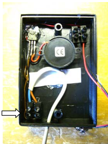
2. Fäst kabeländarna i kabelfästet.
