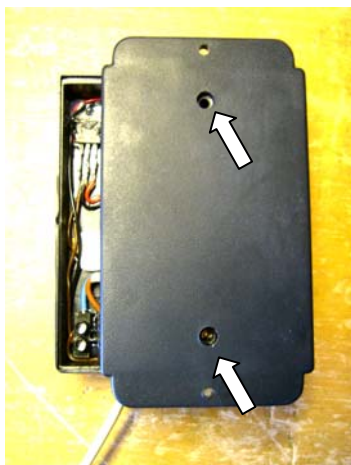
4. Fäst botten med de två medföljande skruvarna.
