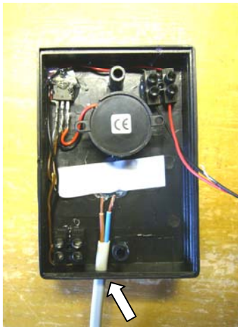
1. Skala kabeländarna. För in kabeln från skyddet genom hålet i botten.
